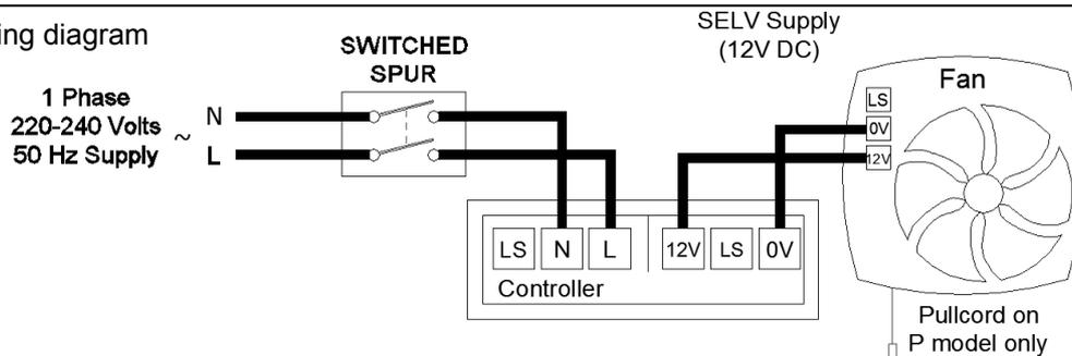
Fig. 9. T/HT wiring diagram
